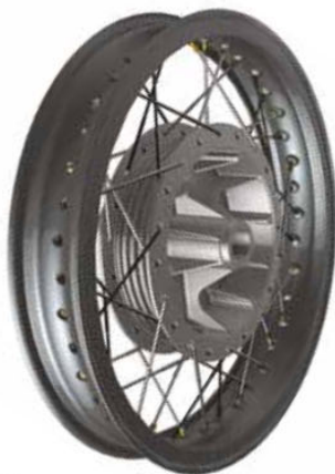
Традиционное спицованное колесо под камерную шину
