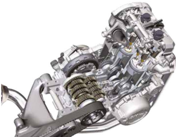
Картер двухцилиндрового двигателя с горизонтальной плоскостью разъема
