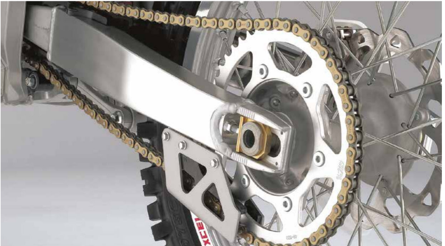
Цепная передача на заднее, ведущее колесо мотоцикла
