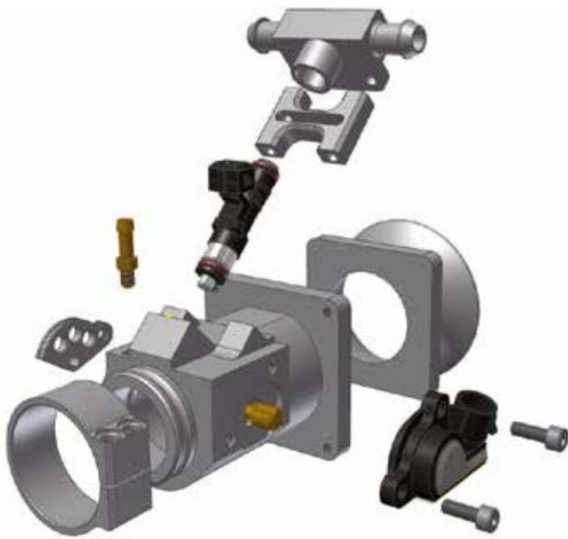
Корпус дроссельной заслонки современного мотоцикла с электронным впрыском топлива
