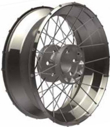
Спицованное колесо для бескамерной шины – спицы крепятся за обод колеса вне воздушной камеры, образуемой ободом и шиной
