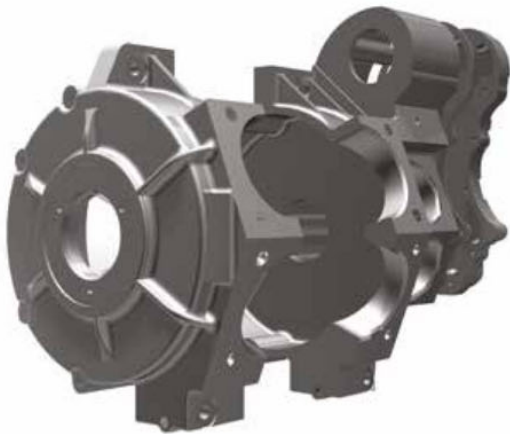
Картер двухцилиндрового V-образного двигателя с вертикальной плоскостью разъема
