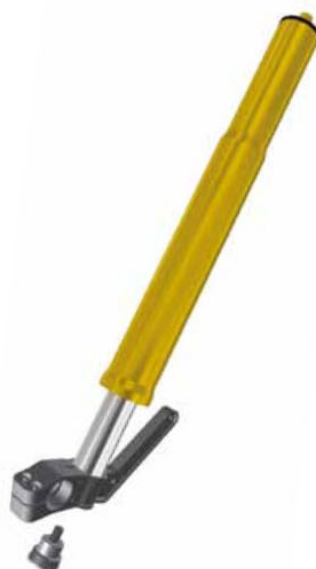
Телескопическая вилка «перевернутого» типа
