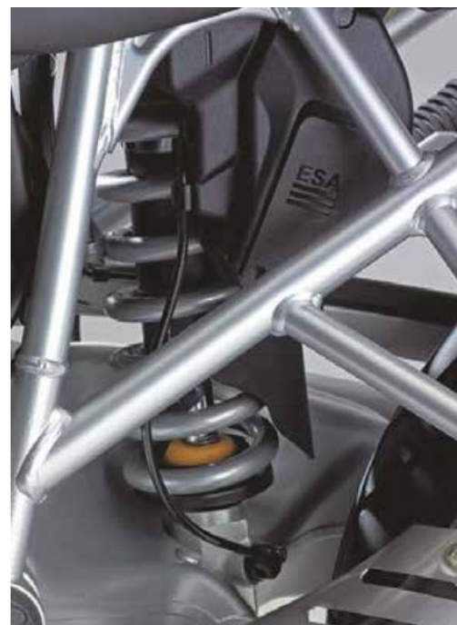
Полностью регулируемый кнопками на руле элемент подвески туристического мотоцикла
