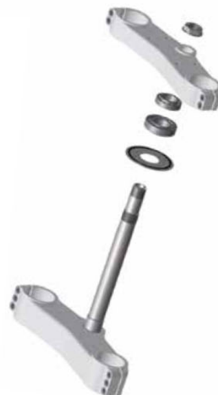
Траверсы телескопической вилки переднего колеса
