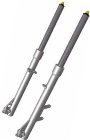
Телескопическая вилка «обычного» типа
